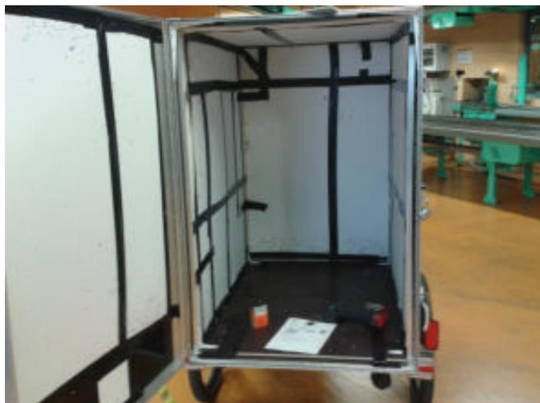
Tests Sanacorp Abbildung 7: Innenraum des Lastenrads mit Styroporisolierung
