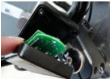
6. **Mangelbeschreibung:** Der sogenannte Tempomat, welcher für die Regelung der Unterstützung zuständig ist, wurde durch einen Wasserschaden beschädigt. Grund war ein Montagefehler, welcher die Abdichtung nicht mehr gewährleistete.
