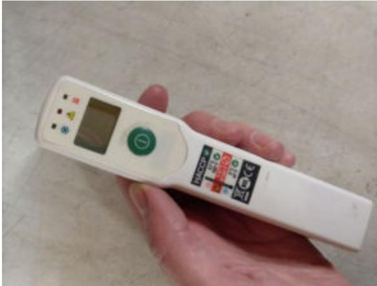
Tests Sanacorp Abbildung 2: Infrarot-Thermometer „Fluke Food Pro“
