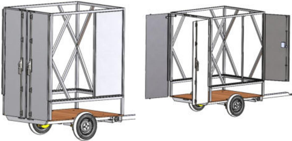
Abbildung 27: Erste Skizzen des Aufbaus von b&p engineering mobility
