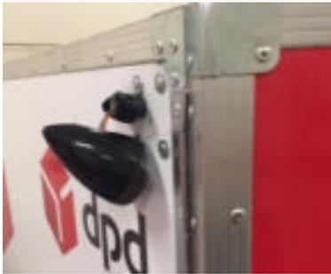
8. **Mangelbeschreibung:** Fangseil der Hauptzugangsklappe ist durch starken Wind abgerissen und hat dabei die hintere Blinkereinheit an der Transportbox beschädigt.
