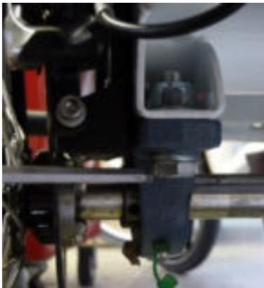
5. **Mangelbeschreibung:** Antriebswelle wandert im Lagersitz. Dadurch wurden mehrere Bauteile beschädigt. Fehlerursache ist eine nicht korrekt ausgeführte Welle-Lager Befestigung. Hierdurch kann bei Kurvenfahrten das Rad nach außen wandern.
