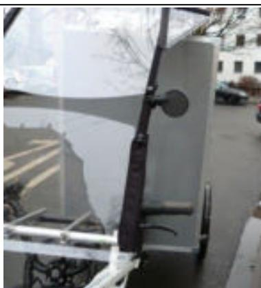
3. **Mangelbeschreibung:** Spiegelarm ist zu kurz, eine Sicht nach Hinten ist nicht möglich. Wetterschutz wurde abmontiert, da er die Fahrer stört und stark windanfällig ist.
