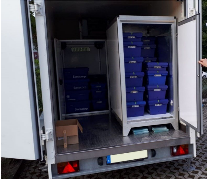
Abbildung 28: Beladener Kühlanhänger, links: Container BRING, rechts: Container A-N.T. © Pedelistics
