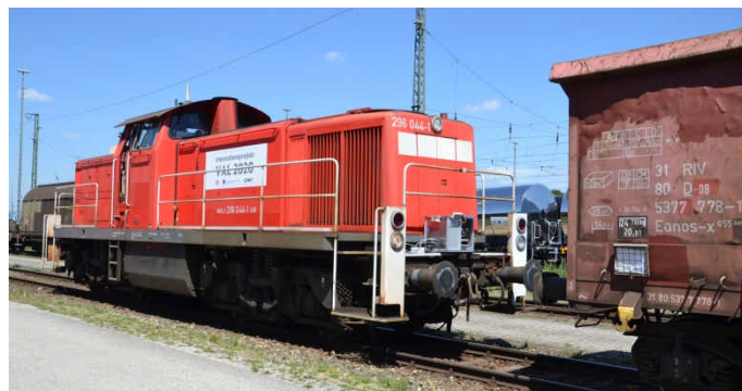
Die vollautomatische Abdrücklokomotive am Rangierbahnhof München Nord; Quelle: A. Bergmeister, TH Nürnberg
