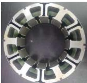
Abb. 1 | Statorblechschnitt mit radialen Flussbarrieren in jedem zweiten Zahn | Quelle: Universität der Bundeswehr
