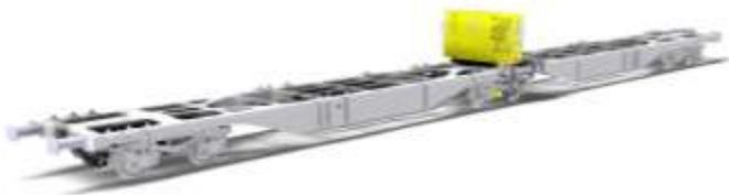
Die SWS PowerBox® kann auf allen Gelenk-Doppelwagen installiert werden | Quelle: SWS PS GmbH
