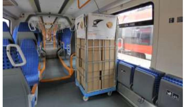
Die Praktikabilität der Mitnahme vorkonfektionierter „Paket-Container“ in Personenbahnen wurde im Rahmen des Projekts mit Hilfe von Gitterboxen getestet | Quelle: TH Würzburg-Schweinfurt
