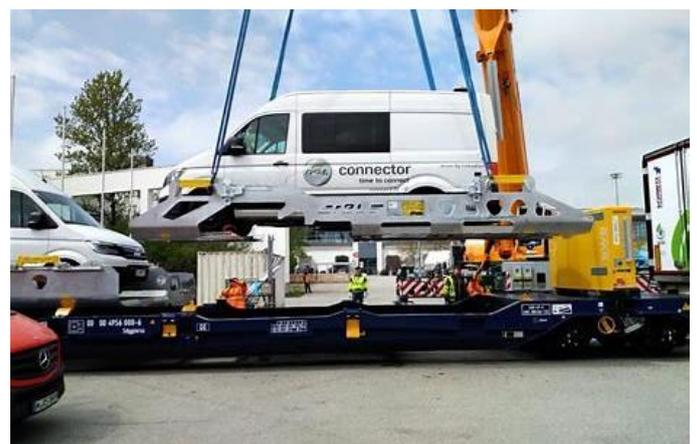
Mit den r2L Connector lassen sich vielfältige Fahrzeuge auf's Gleis setzen | Quelle: r2L
