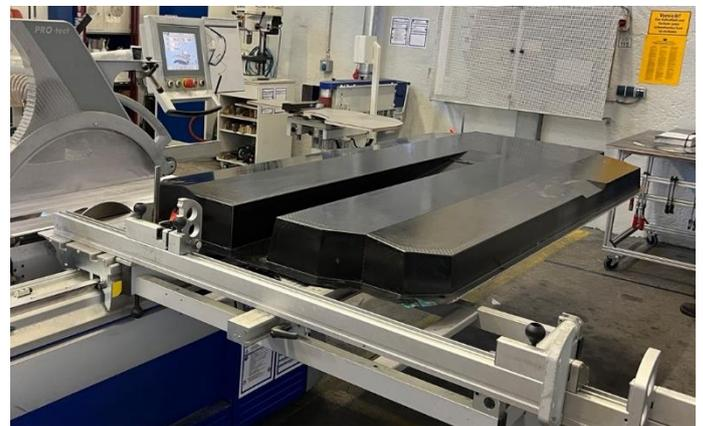
Die Batteriegehäuse des HEERO bestehen aus glasfaserverstärktem Kunststoff, was den Battery Pack leichter, stabiler und effizienter macht | Quelle: E-Works Mobility
