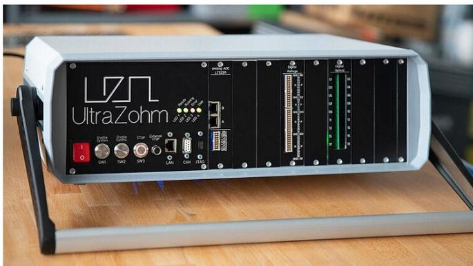
Im Rahmen des Projekts „KI-Power“ wurde die Steuerungsplattform „UltraZohm“ für die Forschung und Entwicklung neuartiger Ansteuer- und Regelungskonzepte im Bereich leistungselektronischer Systeme entwickelt | Quelle: TH Nürnberg
