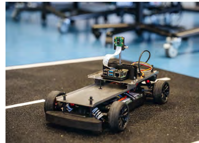
DriveOhm-Modellfahrzeug mit Sensorik als Lernplattform für moderne Fahrzeugsysteme. © Sandra Eichenseher
