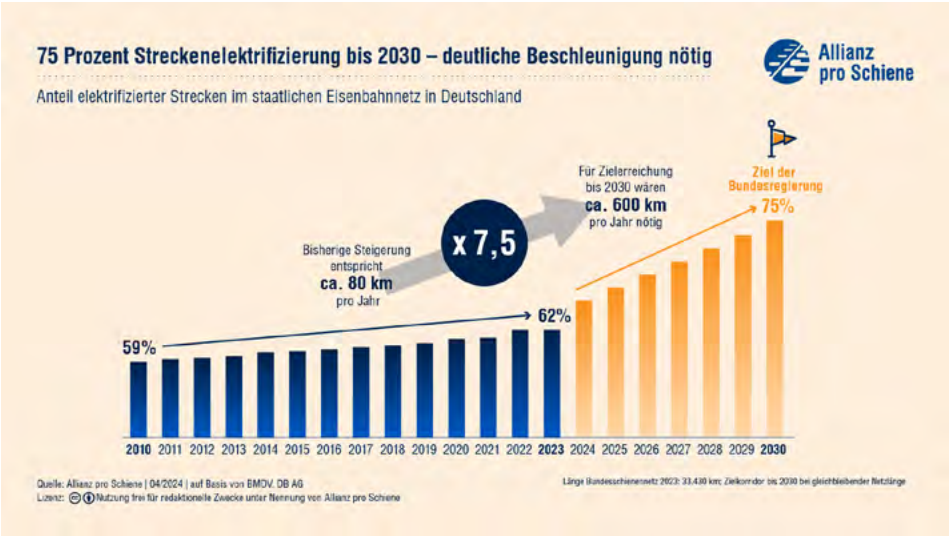
Anteil elektrifizierter Strecken im bundeseigenen Eisenbahnnetz in Deutschland (Quelle: Allianz pro Schiene)
