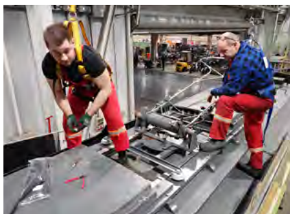
Zwei Mitarbeiter der MPK montieren den drehbaren Lyra-Stromabnehmer auf dem Dach. Aufn.: Johannes Scharf, 29.11.2023
