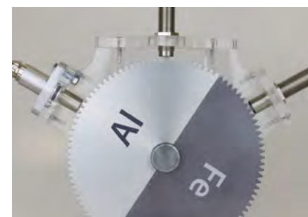
Drehzahlsensoren am Zahnrad
